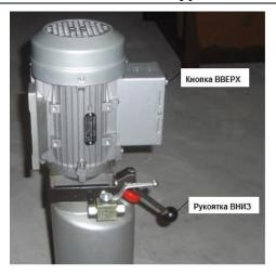
Рис. 27 Стандартное оснащение (гидравлическая станция без пульта управления)
