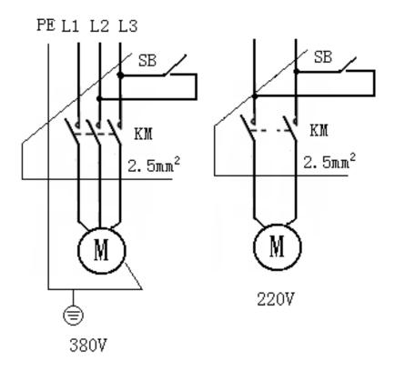
Электрическая схема подъемника без пульта управления
