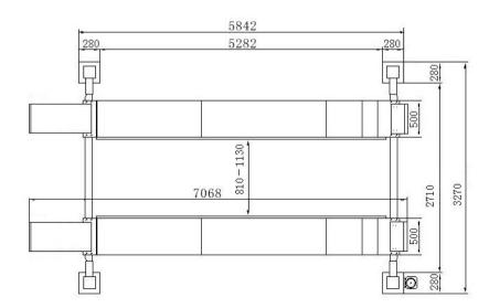
Рис. 3 Размеры подъемника
